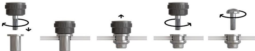
Рис.3.8.4 Схематичный пример монтажа заклепки резьбовой с винтом
