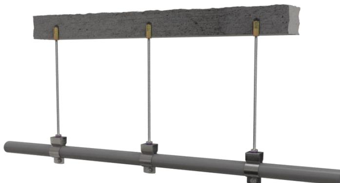
Рис. 3.6.2 Схема монтажа ОКЛ к бетонному перекрытию на примере трубы ВГП
