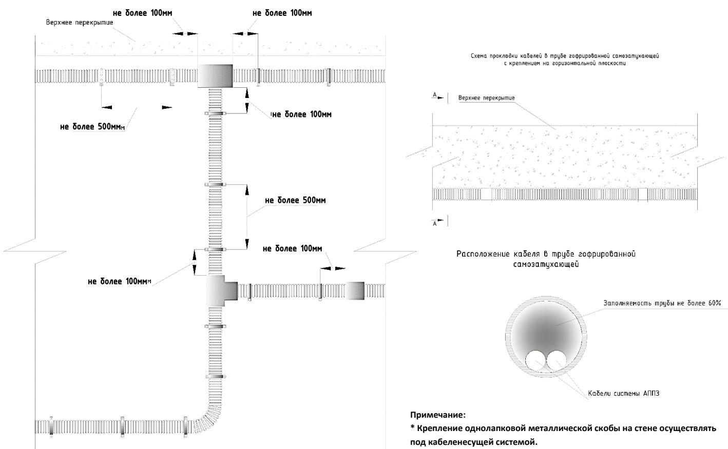
Рис. 2.6.1 Схема монтажа ОКЛ «ПожТехКабель PTK-Line-ТГ FRHF» и «ПожТехКабель PTK-Line-ТГТ СЗ»
