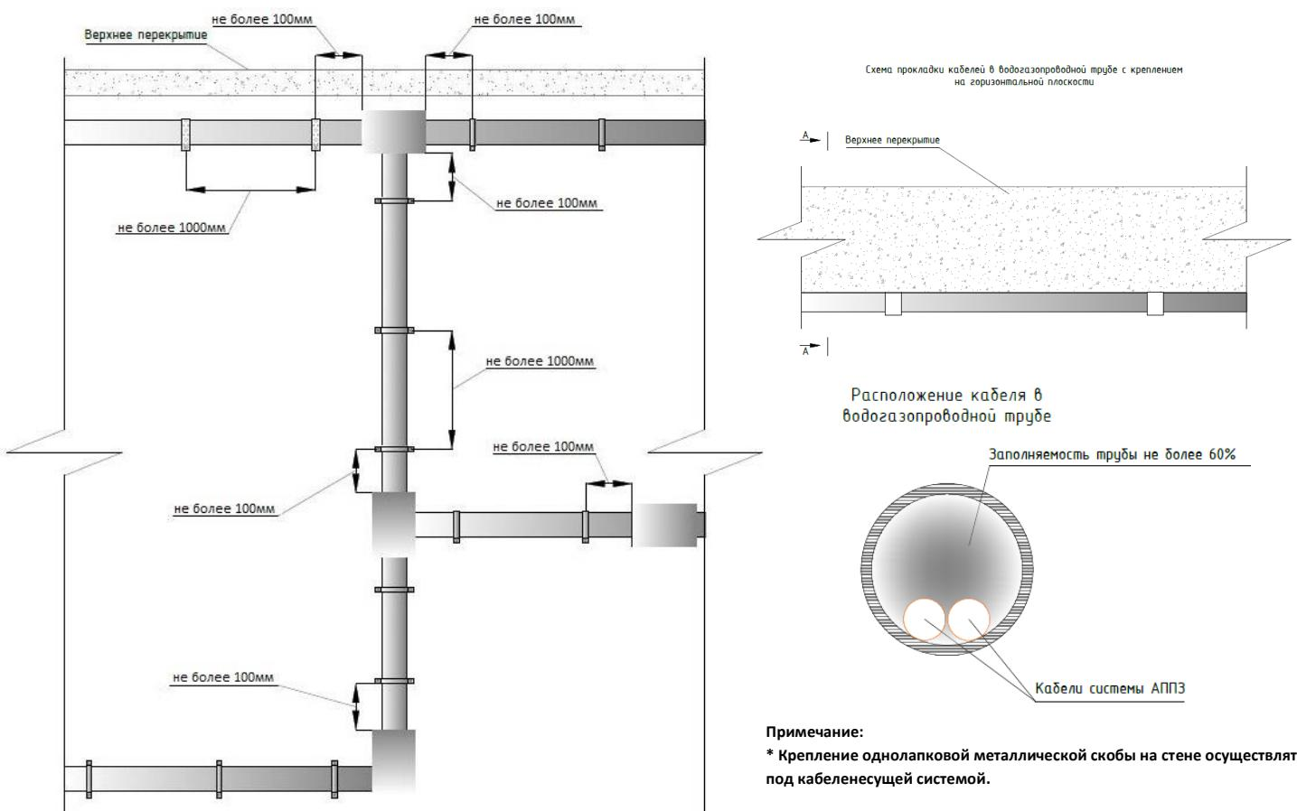
Рис. 2.8.1 Схема монтажа ОКЛ «ПожTexКабель РТК-Line-ТС ВГП»
