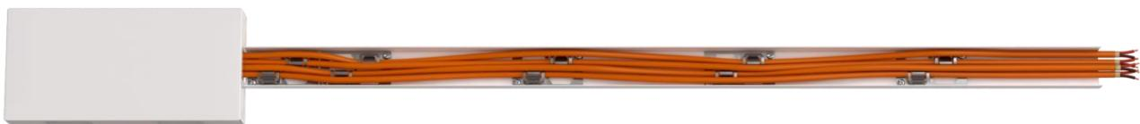
Рис. 2.3.2 Пример прокладки 4-х кабелей в одном кабель-канале 40x25 с применением ДМОУ-2К
