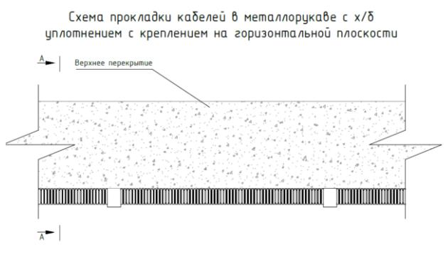
Рис. 2.7.1 Схема монтажа ОКЛ «ПожТехКабель РТК-Line-PM» и «ПожТехКабель РТК-Line-PMП»
