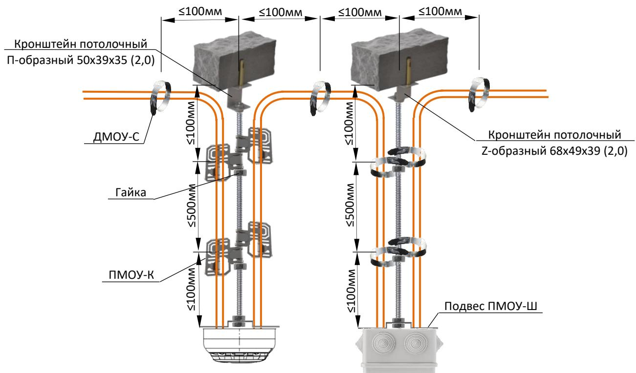
Рис. 5.1.3 Спуск кабеля по шпильке при открытой прокладке
