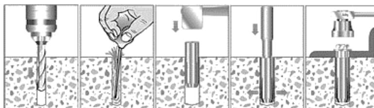
Рис. 3.8.2 Последовательность монтажа
