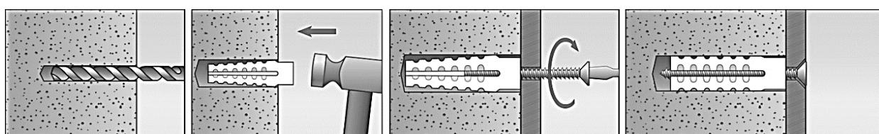
Рис. 2.2.8 Последовательность монтажа дюбеля металлического с саморезом
