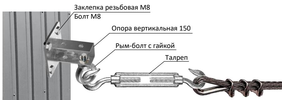
Рис. 7.1.4 Пример узла крепления троса к профильному листу
