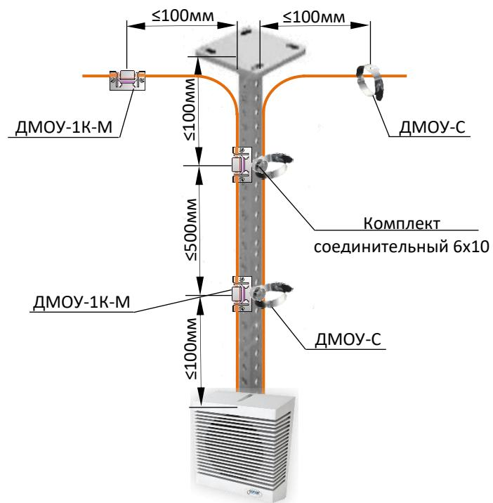
Рис. 5.2.1 Спуск кабеля по стойке консольной сварной при открытой прокладке
