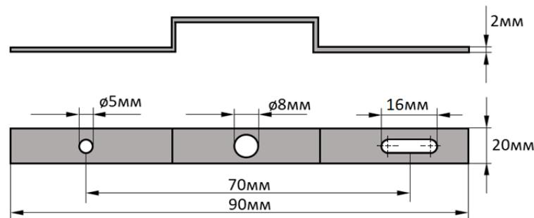
Рис. 3.11.1 Подвес монтажный огнестойкий универсальный на шпильку ПМОУ-Ш
