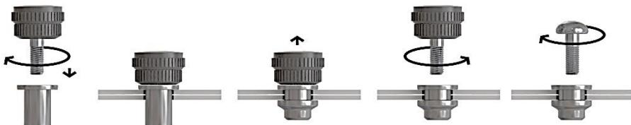
Рис. 4.4.1 Последовательность монтажа заклепки резьбовой с винтом
