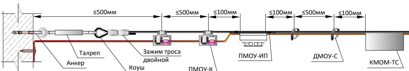
Рис.7.1.1 Схема монтажа ОКЛ РТК-Line-ТСП-ОП
