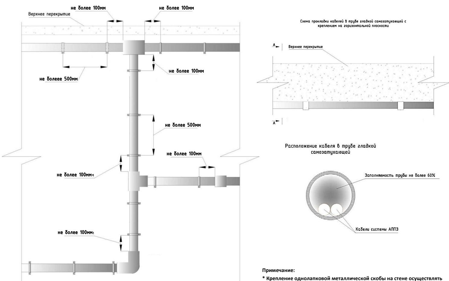
Рис. 2.5.1 Схема монтажа ОКЛ «ПожTexКабель РТК-Line ТГЛ-СЗ»
