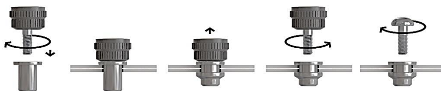
Рис. 4.4.1 Последовательность монтажа заклепки резьбовой с винтом
