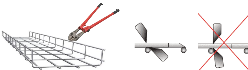
Рис.48 Правила реза проволочного лотка
