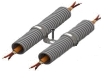
Рис. 3.4.3 Пример прокладки двух параллельных линий
